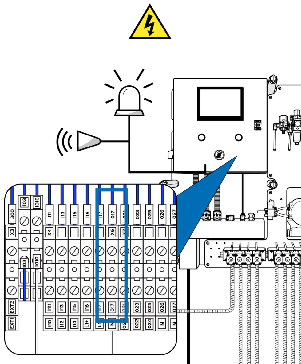
Um einen externen Alarm oder eine Warnleuchte an das System anzuschließen, verwenden Sie den Steckplatz **X6** wie oben abgebildet.
