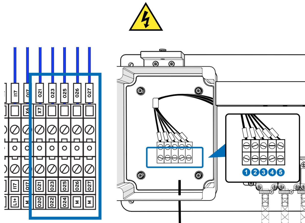
Verwenden Sie ein  $7 \times 1 \text{mm}^2$  Kabel für die Verbindung zwischen der Steuerskabine und dem Verteiler. Schließen Sie den Verteiler an die Klemmleiste X7 an. Jeder Klemmenanschluss entspricht den von links nach rechts nummerierten Ausgängen, wobei die Anzahl von der Reihenfolge abhängig ist. Nachstehend finden Sie den Schaltplan für das Hauptgerät.
