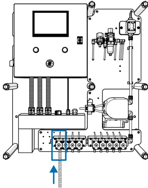
Schließen Sie die Wasserzufuhr an das linke pneumatische Ventil auf der mittleren Platte des Geräts an.
