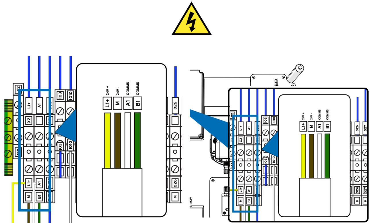
Um den Erweiterungskanal an das Gerät anzuschließen, verbinden Sie X2 am Hauptgerät mit X1 am Erweiterungskanal.
