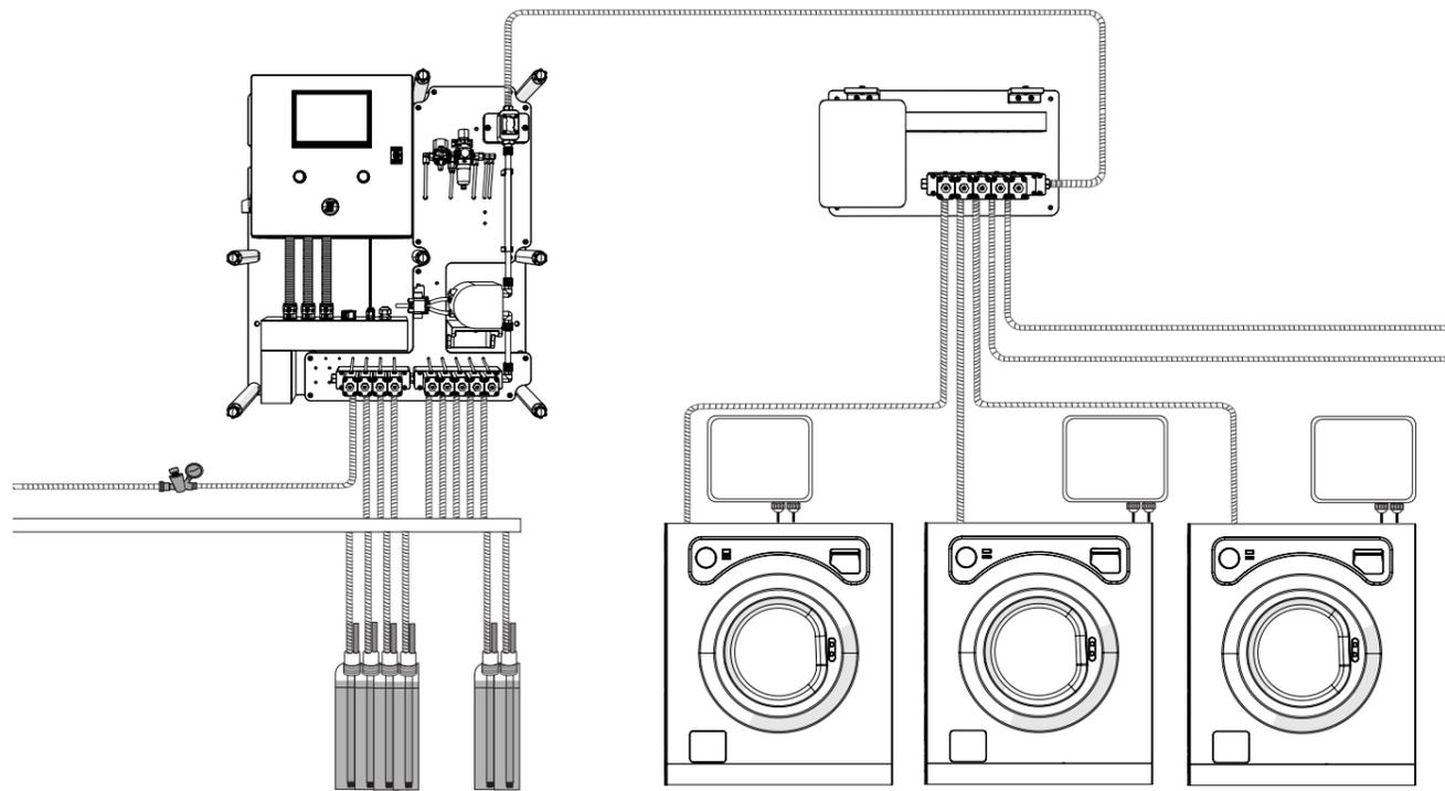
Dieses Bild zeigt die "Standard"-Einrichtung einer Multiplex-Einheit mit einem Kanal, wobei unter "Kanal" eine Gruppe von Produkten zu verstehen ist, die in denselben Verteiler eingespritzt und zu einem Verteiler (Waschmaschinen) oder einer Einspritzung (Tunnel) geleitet werden.
