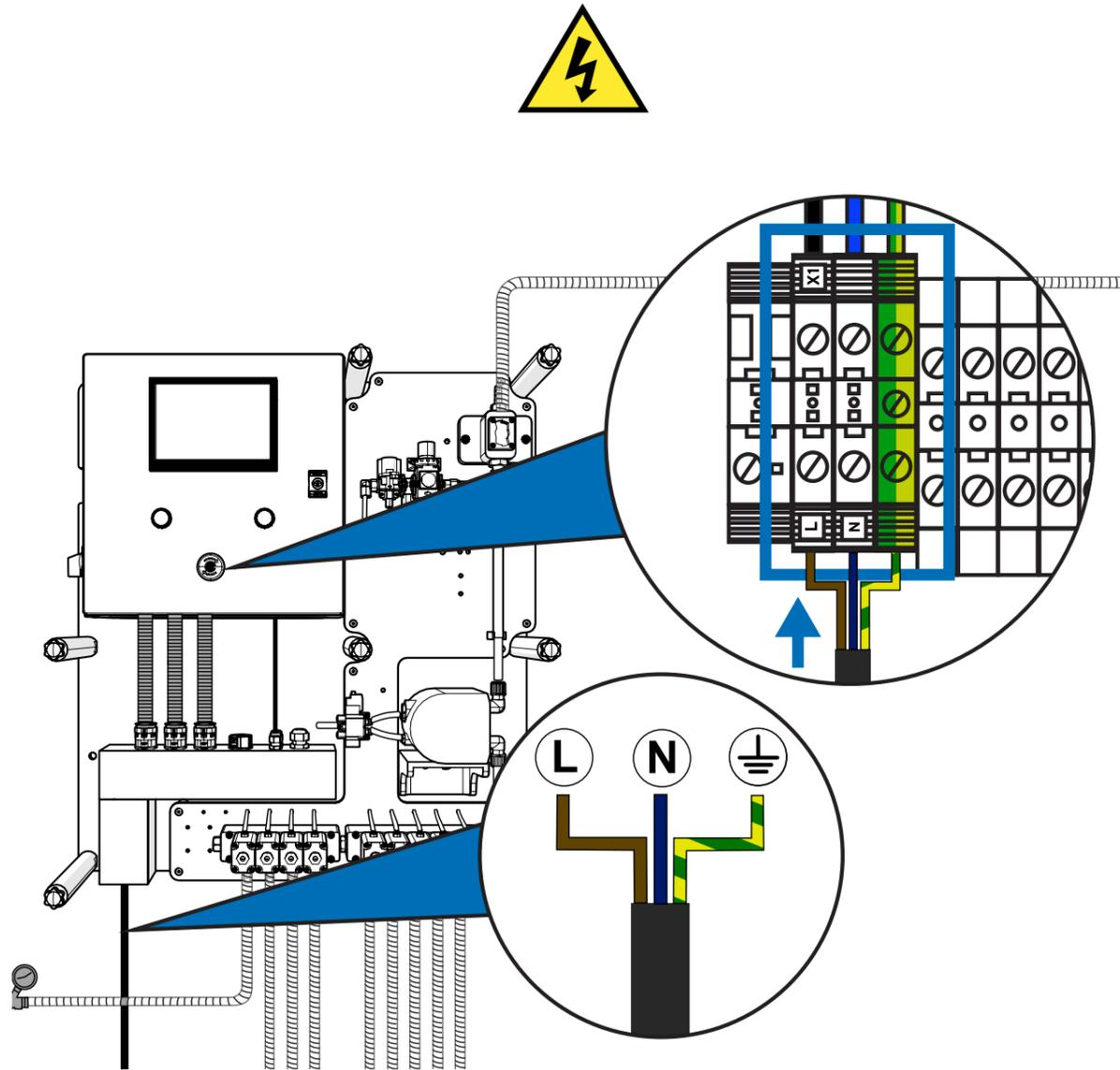
Für die Stromversorgung des Geräts müssen Sie **3x1'5mm<sup>2</sup> Kabel verwenden**. Führen Sie das Kabel durch den Kanal unten links und verwenden Sie eine der Kabelverschraubungen, um es sicher in den Schaltschrank einzuführen. Schließen Sie es an die mit X1 gekennzeichneten Klemmen links unten an den Anschlüssen an. Die Stromversorgung muss in geeigneter Weise geschützt sein. Verwenden Sie eine spezielle Leitung für die Stromversorgung des Geräts.
